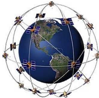
圖 2-7 GPS 衛星分佈在地球上的六個軌道
