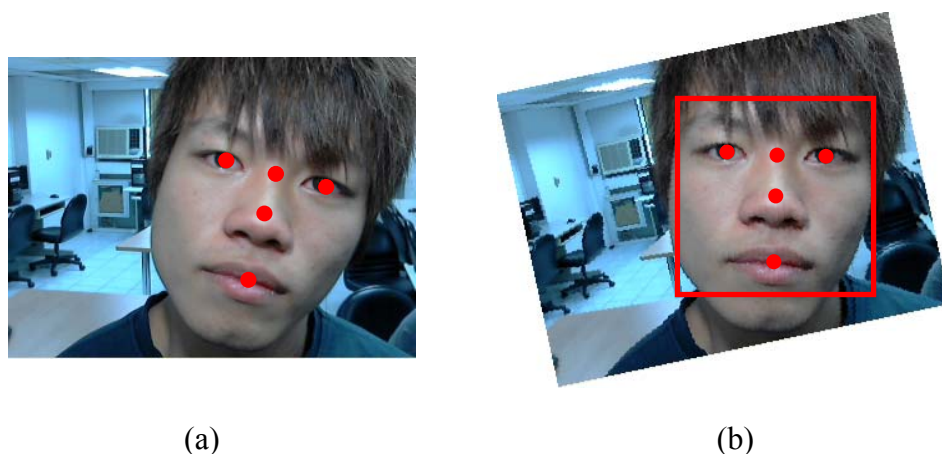
圖2.16 傾斜校正前後人臉圖片 (a)校正前 (b)校正後
