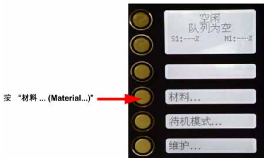
圖 22：將材料匣添加到單材料槽
