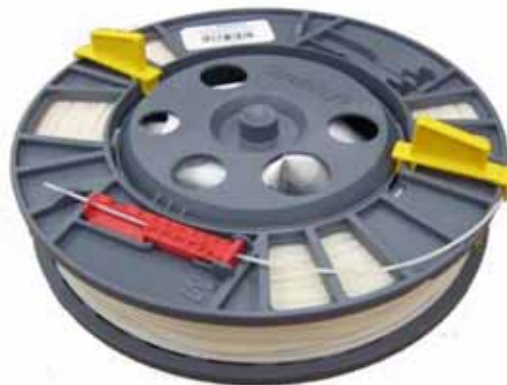
圖 40：正確安裝的材料固定夾。
